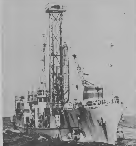
CALDRILL I holds a computer-controlled position while drilling core holes in water 4350 feet deep in the Gulf of Mexico off Texas. CALDRILL I ta mantene un posicon controlá pa computador, durante e boramento den awa na un profundidat di 4,350 pia den Golfo di Mexico cerca di Texas.
